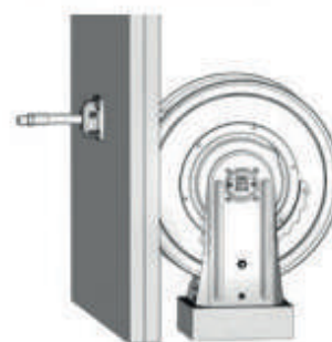
Montage sur camion avec guide de rouleau monté à distance
